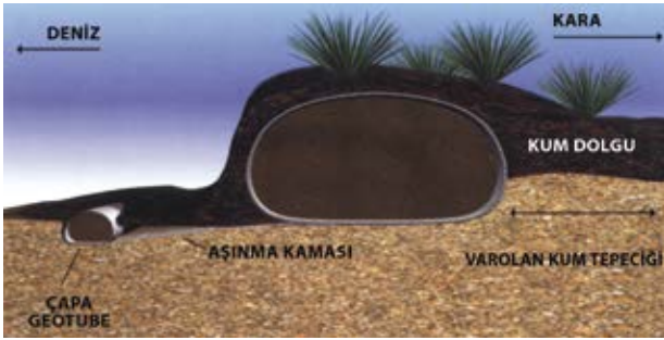
TenCate Geotube® sistemi kum tepesiği kesişim noktası
