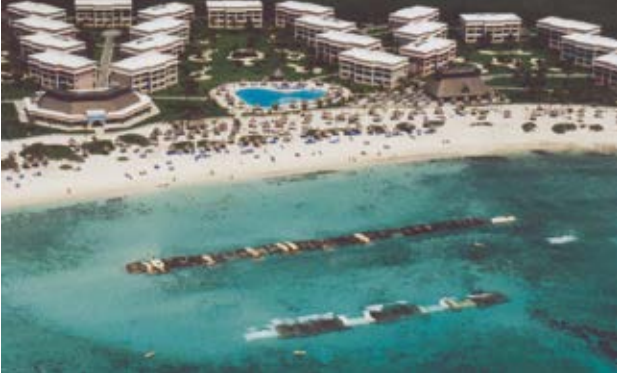
Dalgakıran olarak açıkta konumlanmış TenCate Geotube® sistemleri.
